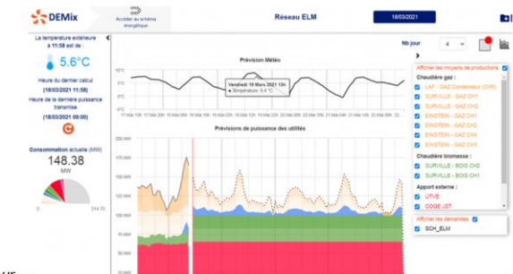
Figure 11 : vue prévision de charge système sous DEMix
